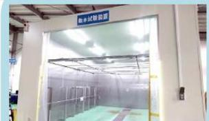
工業製品の防雨性能を検査する試験室です。200mm/h相当の散水が可能です。
