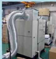
エンジンの試験を行う際に一定の温湿度空気を供給する設備です。
