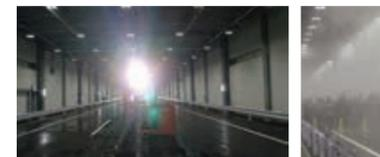
日照試験設備では、太陽を模擬したライトを設置し、西日などの逆光を再現できる
