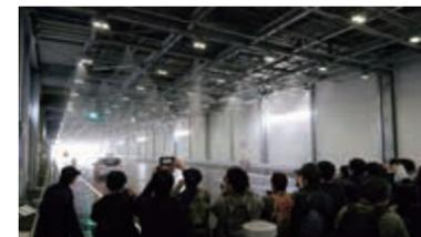
降雨設備では、1時間あたりの雨量を30mm、50mm、80mmの3段階で再現できる
